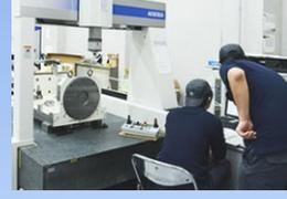
三次元測定機を備えた恒温室で、完成品の検査を実施します。
