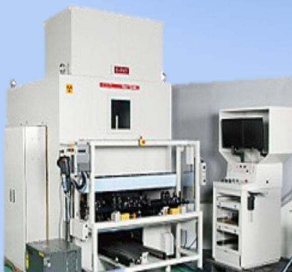
アルミ製品などの量産品検査目的の特別仕様装置です。ハンドリングには多関節ロボットを使用しています。操作性を最大限にユーザーの要望を加味しています。
