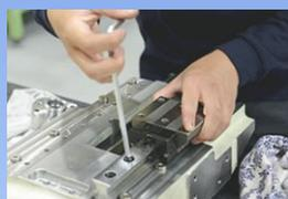
仕上がった部品を、組図に基づいて組み付け、調整を行います。
