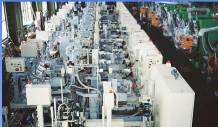
高精度かつ高効率の機械加工には欠かせないトランスファーマシンを製造し、国内外の自動車産業・電子部品産業を中心に多数の納入実績を誇っています。生産量、ワークの種類・ロット数に応じて、長年の経験、豊富な加工技術、数多くの製造実績により、ニーズに叶った最適な生産システムを構築します。
