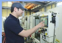
組立が完成した機械が操作通りに動作するように、電気面での調整を行います。
