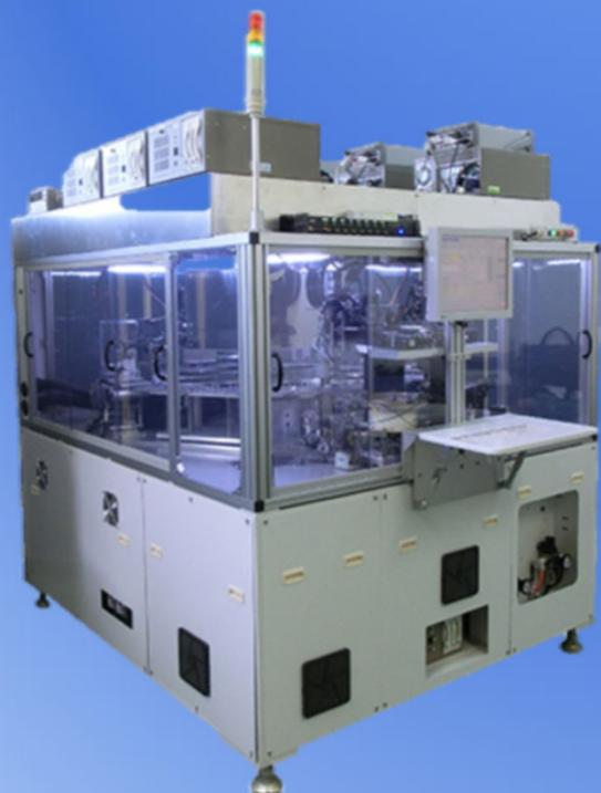
インデックステーブルの周囲に配置したペルチェ式温調ユニットより、連続的に温度特性検査を行う装置です。
