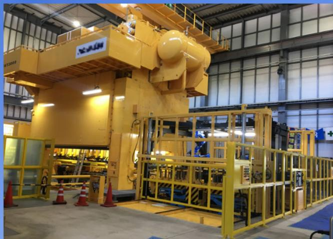
自動車メーカー向けのプレス機械用自動化装置を各種設計、製作しております。適用範囲は主とし板金用プレスでタンデムプレスライン、トランスファプレスライン、ブランキングプレスラインの前後設備や中間搬送設備およびその他の付属装置です。
